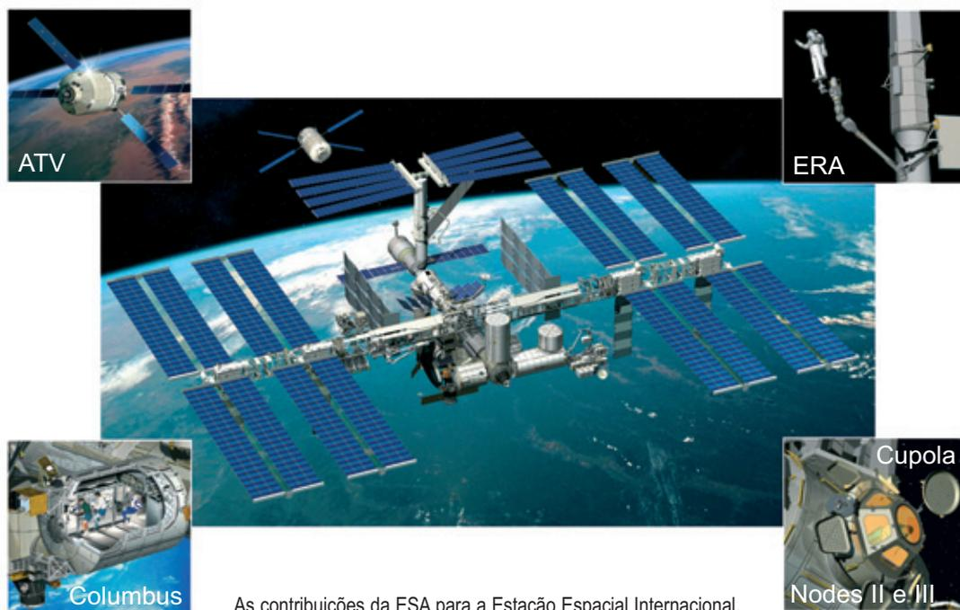
A Estação Espacial possui grandes painéis solares para abastecimento de energia. As superfícies rectangulares dos painéis solares são azuis, os radiadores são cinzentos e parecem quase um acordeão. Os radiadores garantem que o excesso de calor é afastado da Estação Espacial, para arrefecê-la quando está virada para o Sol. Existem também compartimentos de acoplamento para as naves espaciais e a sonda Soyuz está permanentemente acoplada à Estação Espacial para ser usada como veículo de salvamento.
